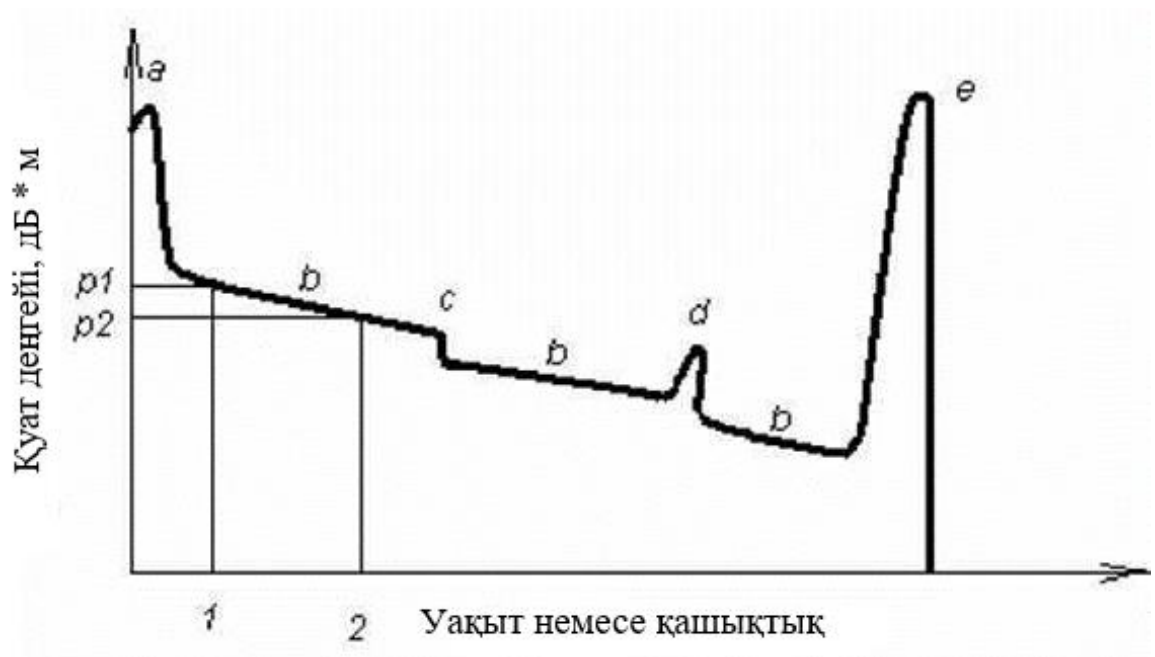
1.3 Сурет- Электр жеткізу желісінің әдеттегі шағылысуы. Тік оське логарифмдік шкала бойынша, динамикаға оралған импульстардың салыстырмалы күші және көлденең ось бойынша шағылысу орны.
